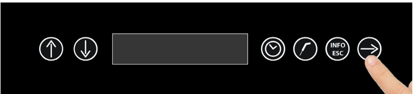
Nach dem Drücken der Taste „BESTÄTIGUNG“ kann der Kerntemperaturfühler eingesetzt werden.
