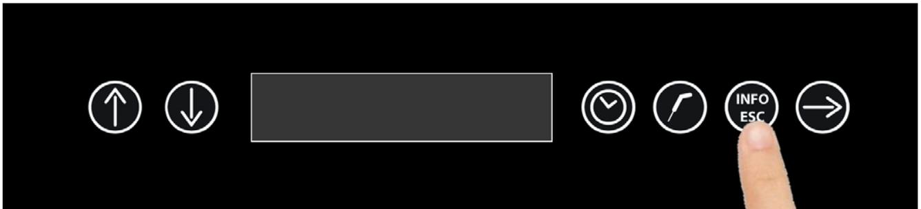
Wird am Display „STOP“ angezeigt, drücken Sie die Taste „INFO-ESC“.
