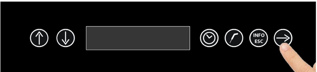
Drücken Sie die Taste „BESTÄTIGUNG“. Sofern Alarme vorhanden sind, beginnt die Anzeige mit dem Alarm 01
