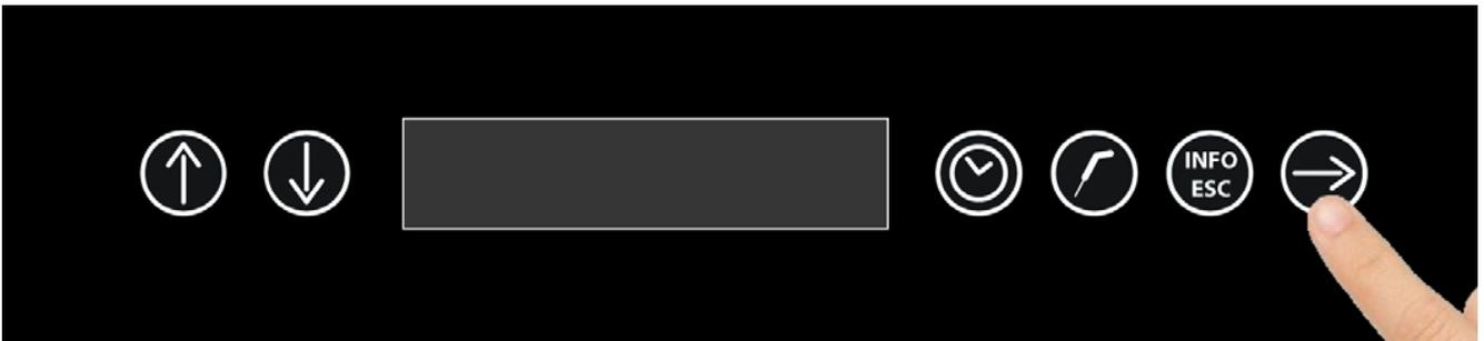
Nach dem Drücken der Taste „BESTÄTIGUNG“ kann die Temperatur im inneren des Geräts eingestellt werden.
