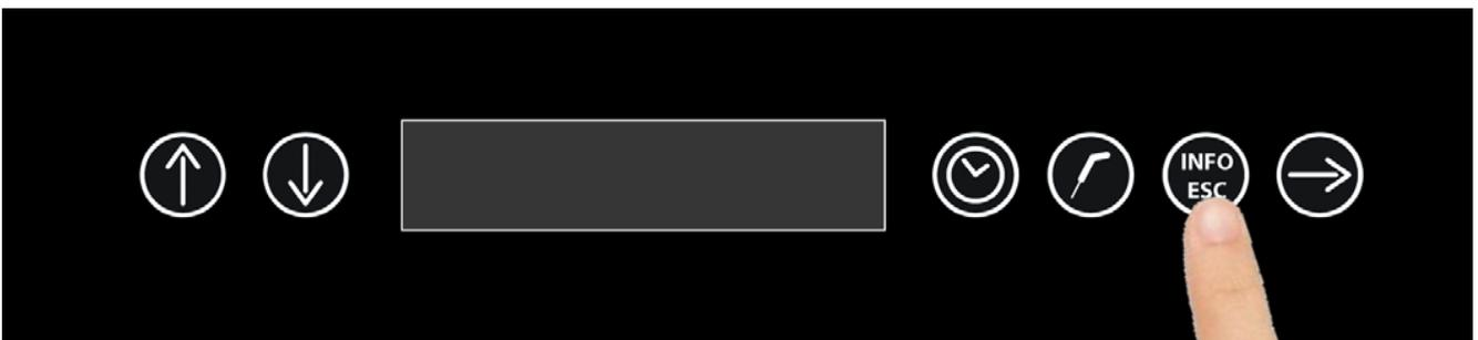
Wird am Display „STOP“ angezeigt, drücken Sie die Taste „INFO-ESC“.
