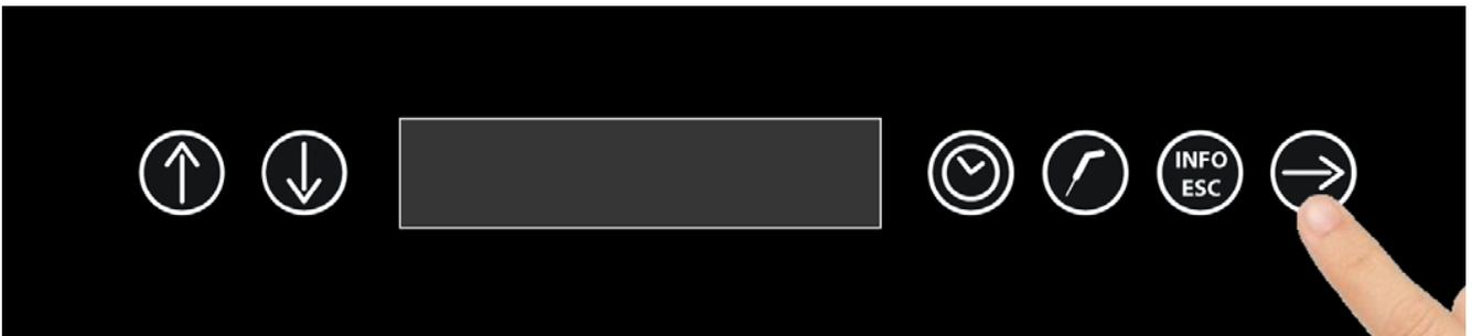
Nach dem Drücken der Taste „BESTÄTIGUNG“ kann die Temperatur im inneren des Geräts eingestellt werden.
